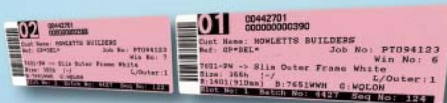
THE LABEL DISPLAYS A COMPLETE COPY OF THE CURRENT LABEL AS OUTPUT FROM THE OFFICE WINDOW DESIGNING PACKAGE. A LABEL IS PRINTED AS EACH CUT PIECE IS PRESENTED TO THE OPERATOR, PREVENTING LABEL SEQUENCE ERRORS. THE SLOT NUMBER IS CLEARLY DISPLAYED IN LARGE PRINT FOR EASE OF TROLLEY SORTING.
